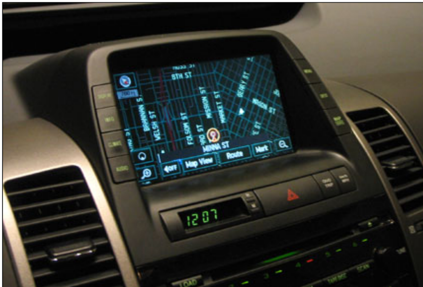
รูปที่ 5.10 อุปกรณ์ที่มี Embedded computer บนรถยนต์
